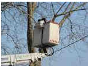
Chaque année, des accidents graves ont lieu lorsque des appareils de levage de charges (automoteur à mat télescopique, chariot à mat élévateur, chargeur frontal...) sont utilisés pour lever des personnes. L'apparition des « télescopiques » a entraîné le détournement de leur usage initial vers l'élagage d'arbres, le bâchage de tas de fourrage, l'entretien de bâtiments (nettoyage de toiture, remplacement d'éclairage...) ou la maintenance d'installations.
